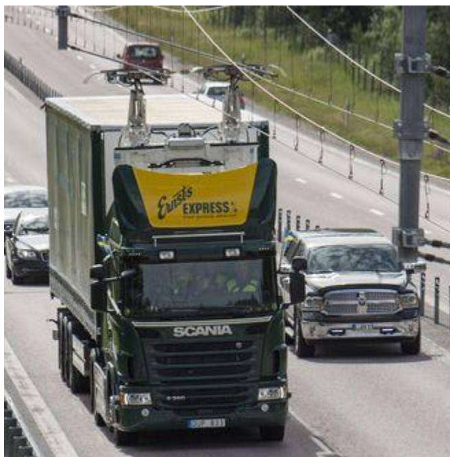
Figur 27: Scania lastebil med pantograflading via Kjøreledning over Elvåg E16 i Sandviken i Sverige.
